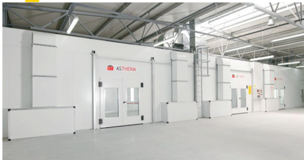
Zestaw dwóch kabin lakierniczych współpracujących z jedną suszarnią to profesjonalna inwestycja średniej wielkości producenta mebli.
